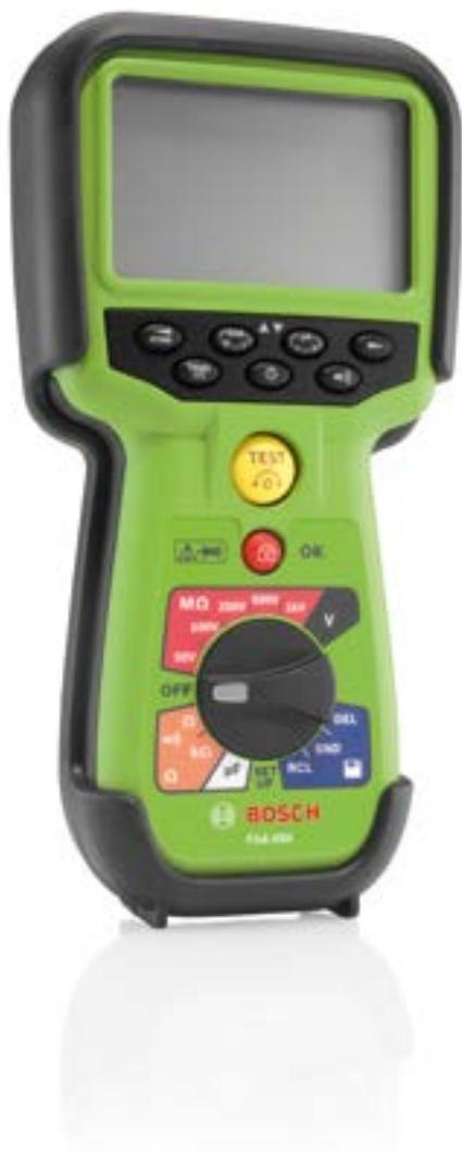
Der FSA 050 ist ein wichtiger und einfacher Diagnose-Baustein zur Prüfung von Fahrzeugen mit Elektro- und Hybridantrieb. Das Gerät funktioniert kabellos und ist in der Lage Multimeterfunktionen wie Spannungs-, Widerstands-, Kapazitäts-, Isolations- und Durchgangsprüfungen durchzuführen. Messungen auf Hochvoltseite bis 600 V (CAT IV1) sowie das Prüfen des Isolationswiderstands bis 200 GOhm bei Prüfspannungen von 50 bis 1000 V sind ebenfalls kein Problem.
