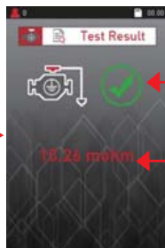
El resultado de la prueba indica que la conexión a tierra es buena.
