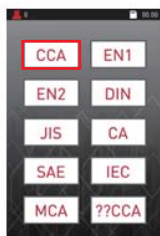
Seleccione la medida de prueba según su batería
