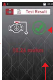
Testergebnis, die Bodenverbindung angab, ist gut.
