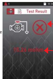
I risultati del test indicano che la connessione di massa a terra non è buona.
