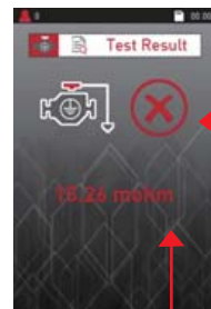
Testergebnis, die Bodenverbindung angab, ist nicht gut.
