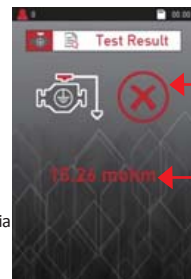
El resultado de la prueba indica que la conexión a tierra no es buena.
