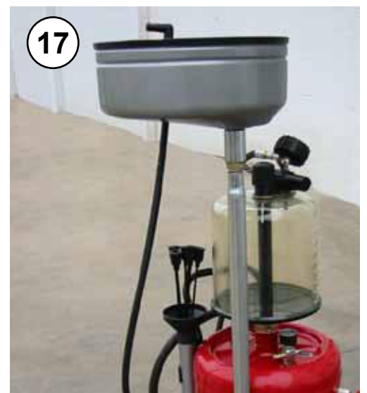
17 Inserire la vasca e le sonde Insert the bowl and the brobes Insérer le bac et les sondes Die Schale und den Fühler einstellen
