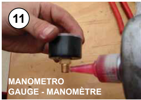
Applicare del sigillante sulla filettatura Put some sealant on the thread Mettre de la loctite sur le filetage Die Gewinde versiegeln
