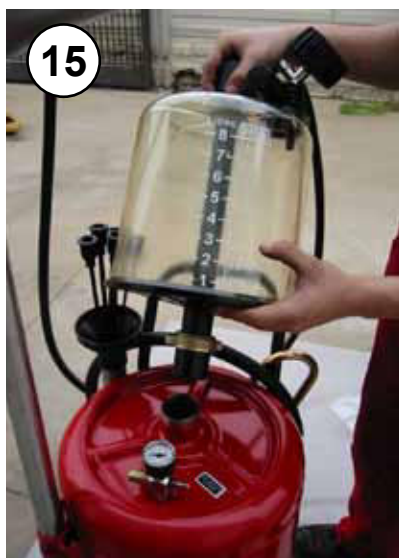
15 Montare il visore Mount the viewer Monter le voyant Der Messbecher einbauen
