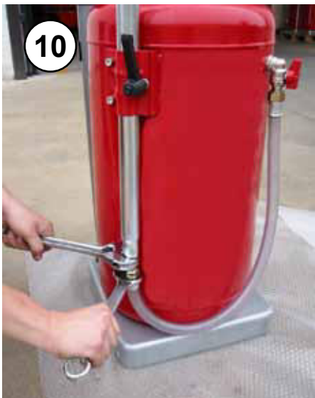
10 Montare il tubo flessibile di recupero Mount the recovery flexible hose Monter le tuyau flexible de récupération Den Entsorgungsschlauch einbauen
