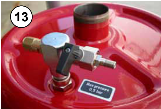
13 Montare il raccordo fornito sulla valvola di pressurizzazione o un innesto rapido a scelta utilizzando del sigillante sulla filettatura Mount the fitting supplied on the pressurization valve or a quick coupling by using some sealant on the thread Monter le raccord fourni sur la soupape de pressurisation ou un raccord rapide à choix en employant de la loctite sur le filetage Die ausgestattete Verbindung oder einen Schnellverbindung auf dem Druckventil mit einer Versiegelung auf dem Gewinde einbauen
