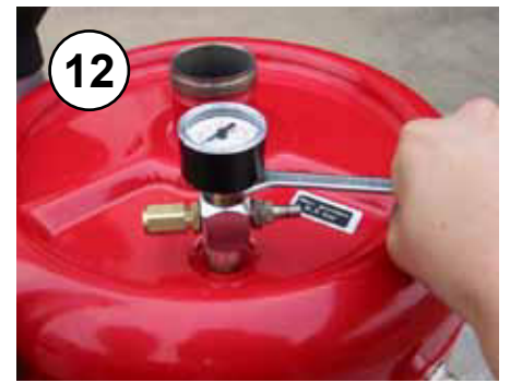
12 Fissare il manometro Fix the gauge Fixer le manomètre Das Manometer befestigen
