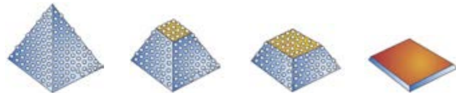
Abschleifverhalten der Pyramidenstruktur
