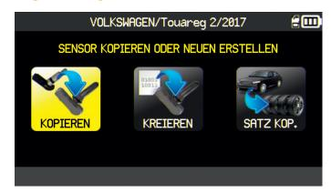
Programmierung von Universalsensoren, fünf Räder gleichzeitig, ideal für Winterräder. Auswahl nach Sensorhersteller oder Fahrzeugmodell und Baujahr.
