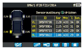
Anzeige aller Sensorinformationen für alle vier Reifen, einschließlich Sensor-ID, Druck, Frequenz, Temperatur und Batteriestatus.
