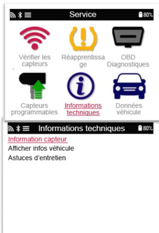
**Informations techniques** Donne des informations détaillées sur les pièces de rechange, les kits d'entretien, les capteurs, les véhicules et les conseils d'entretien.
