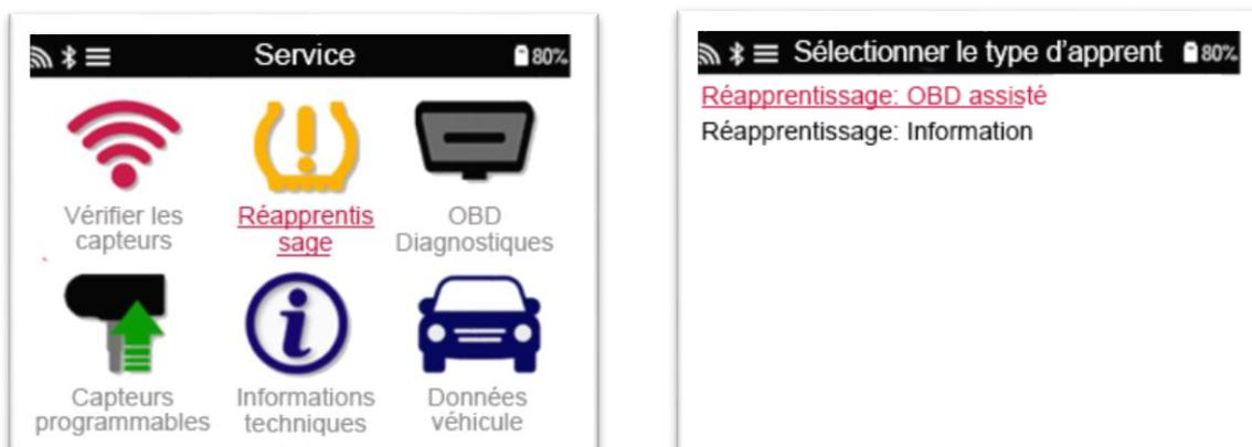
Pour savoir quel type de réapprentissage est disponible pour un véhicule, il suffit d'allumer l'outil et de sélectionner Ré-apprendre. Ou consultez la liste des couvertures actuelles à l'adresse [www.bartecautoid.com](http://www.bartecautoid.com) > Téléchargements.
