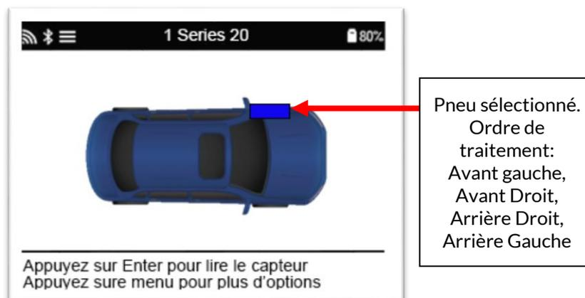
En plus de la pression et de la température, nous affichons également le "mode" du capteur. Dans certains cas, le mode ne peut être changé et n'est pas important, mais dans d'autres cas, il devra être changé pour que le réapprentissage fonctionne.
