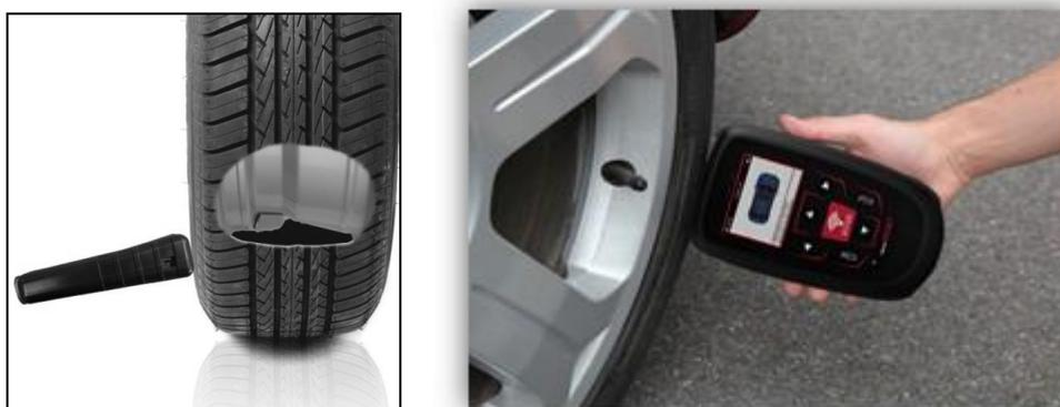
(Remarque : avec les capteurs Ford Banded, l'outil doit être maintenu à 180°/opposé par rapport à la position de la tige)
