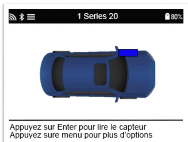
Utilisez les touches fléchées pour sélectionner le capteur qui doit être lu.
