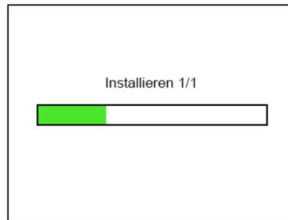
Bitte trennen Sie das OBDII-Modul nicht vom Fahrzeug, schalten Sie den TECH600 nicht aus und beenden Sie die Installation des Updates nicht, während dieser Bildschirm angezeigt wird.
