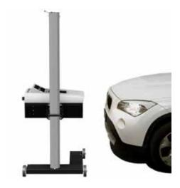
Die Zentriervorrichtung der Scheinwerfer in einem Abstand von circa 30 cm vor den rechten Scheinwerfer des Autos stellen, den Abstand zwischen Boden und Scheinwerfermitte messen und die optische Kammer auf die entsprechende Höhe einstellen; dazu die Gradskala des Ständers verwenden. Als Skalenindex den oberen Teil des Gleitschuhs verwenden.
