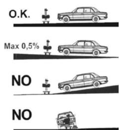
Während dem Scheinwerfertest muss die Bodenfläche eben sein. Wenn das nicht möglich sein sollte, müssen die Zentriervorrichtung der Scheinwerfer und das Fahrzeug zumindest auf einer Fläche mit gleichmäßigem Höhenunterschied platziert werden, allerdings mit einer Neigung, die 0,5% nicht überschreitet.
