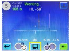
Schließen Sie das Diagnosegerät an. Stellen Sie die Scheinwerfer über das Diagnosegerät auf die "Grundeinstellungen" ein.
