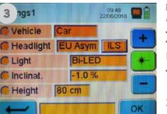
NOTIEREN: Zum Einstellen der Scheinwerfer mit Abblendlicht (ILS) müssen die Scheinwerfer mit dem Diagnosegerät in den Grundeinstellungsmodus gebracht werden, um ein Testbild zu erzeugen. Nur so sind Tests und Anpassungen möglich!
