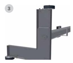
3. Die Schraube und die Unterlegscheibe wieder anbringen, dabei die 2 Bohrungen mit den Stiften zentrieren.
