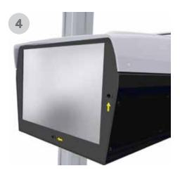
4. Um die Zentrierung des Scheinwerfers zu erleichtern, hat die optische Kiste vorne zwei Klasse 2 Laserlichtern mit einer Wellenlänge von 635 nm (Nanometer) und einer Leistung von> = 1 mW (Milliwatt) Winkel von 90° wir im an der Seite Abbildung repräsentiert, die zwei Laser bilden zusammen ein Kreuz in einem Mindestabstand von 14cm von der optischen Kiste. Symbol für Laserstrahlung der Klasse 2 an der Seite der optischen Kiste.
