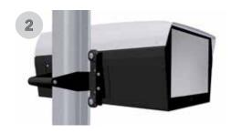
2. Die optische Kammer ist durch Gleiten auf präzisen und geräuschlosen Kunststoff-Gleitschuhen an einem gezogenen Aluminiumständer höhenregulierbar; der Ständer ist mit einer Zentimeterskala zur genauen Positionierung auf den Scheinwerfer bezogen, versehen.
