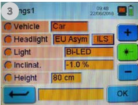
NOTE: Pour le réglage des phares à faisceau haut anti-éblouissement (ILS), il est nécessaire de basculer les phares en mode paramètres de base au moyen du dispositif de diagnostic pour générer un motif de test. Ce n'est qu'ainsi que le test et les réglages peuvent être effectués.
