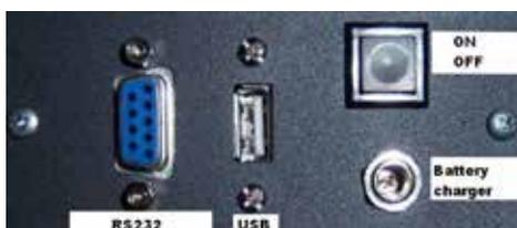
Le côté droit de la chambre optique présente le bouton de mise en marche et d'arrêt du dispositif, un connecteur RS232 de communication, et un système pour la mise à jour du système via port USB.
