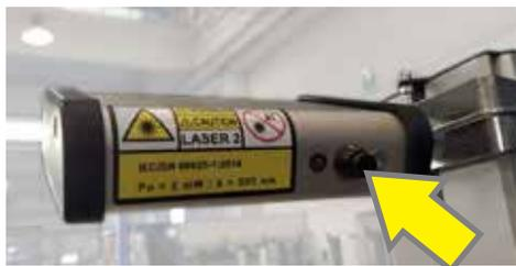
Trouver deux détails, sur l'avant du véhicule, parfaitement symétriques l'un par rapport à l'autre (par exemple, le haut du pare-brise ou les phares), allumer le laser en pressant le bouton illustré ci-contre, tourner le boîtier optique jusqu'à ce que les deux points de repère rencontre la ligne rouge du laser.
