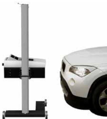
Placer le réglôphare devant le phare droit de la voiture à une distance de 20 à 50 cm, mesurer la hauteur entre le sol et le centre du phare et régler la chambre optique à la hauteur correspondante à l'aide de l'échelle graduée sur la colonne. Utiliser la partie supérieure du bloc de coulissement à titre d'échelle.
