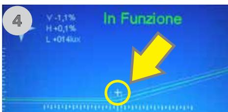
NOTE: Cet écran montre l'image du faisceau lumineux projeté sur l'écran interne vers le boîtier optique permettant de contrôler la position en mode REAL.
