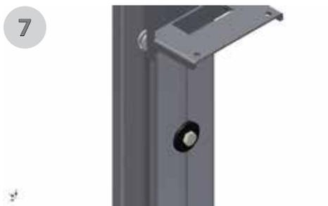
7. Positionner le dispositif au-dessus des rails précédemment installés, enlever la vis et les rondelles maintenant le contrepoids en partie basse de la colonne.
