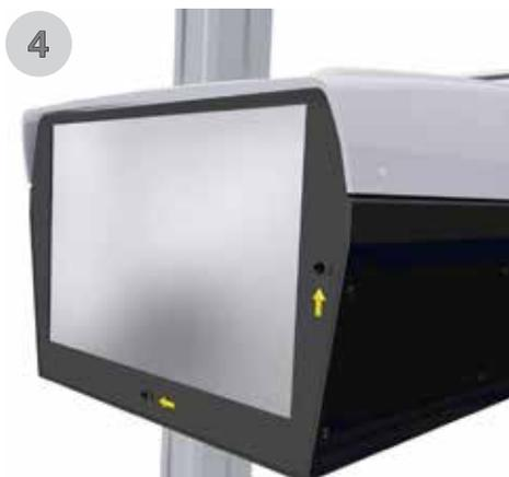
Afin de centrer le dispositif sur la source lumineuse, la façade est équipée d'un émetteur à 2 raies de laser classe 2, la longueur d'onde est de 635 nm (nanomètres) et la puissance est  $\leq 1$  mW (milliwatts), l'angle du ventilateur est de 90°, mis en évidence dans l'image ci-contre, créant une croix à partir de 14cm vers la boîte optique Symbole de rayon laser classe 2, appliqué sur le côté du boîtier optique.
