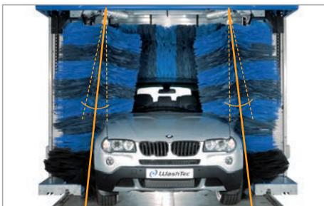
Die Seitenwäscher werden beim Waschvorgang schräggestellt – in einem automatisch an die Fahrzeugform angepassten Winkel. Das sichert ein hervorragendes Waschergebnis bei allen Fahrzeugformen.
