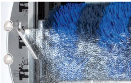
Das konturfolgende Sprüharmsystem arbeitet nahe am Auto und garantiert so einen sparsamen Einsatz von Wasser und Chemie.
