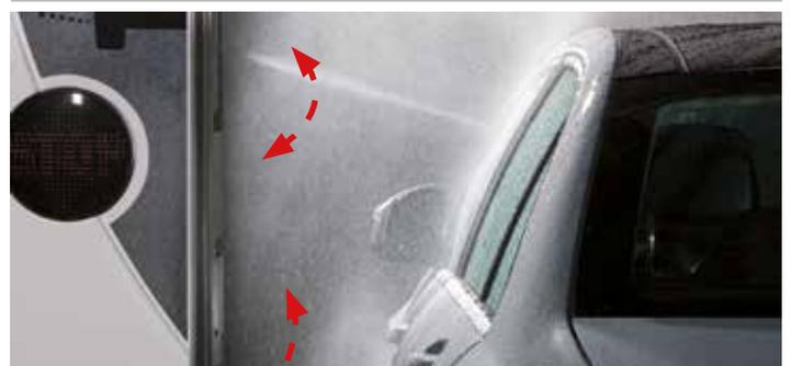
Les buses oscillantes et orientables du SwivelJet permettent d'éliminer efficacement la saleté sur l'avant, l'arrière et le bas de caisse du véhicule.
