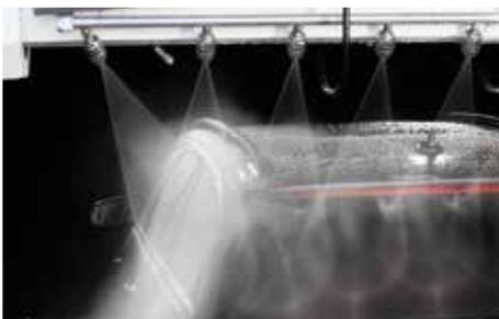
Haute pression TurboNozzles à jet rotatif très puissant, buses oscillantes, ou encore buses classiques à jet plat : les différents systèmes haute pression disponibles permettent d'éliminer efficacement la saleté et la boue sur l'avant, l'arrière et le bas de caisse du véhicule.
