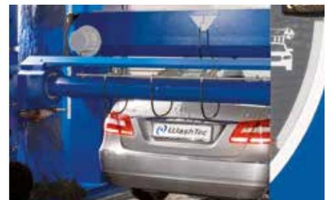
La forme des sècheurs horizontaux a été optimisée pour canaliser le flux d'air sur les parties les plus difficiles, et éliminer les gouttes résiduelles du lavage. Les sècheurs sont disponibles en version oscillante ou pivotante.
