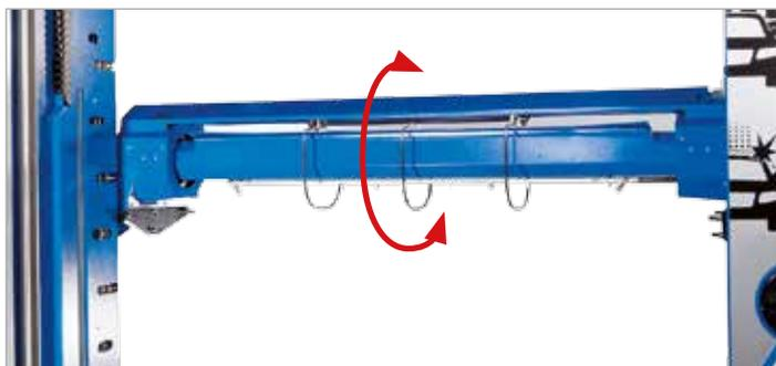
La buse de toit rotative FlexStream supporte 3 fonctions : application de produits de lavage, lavage haute pression et séchage. Encore plus efficace grâce à sa rotation complète permettant un suivi optimal du profil du véhicule.
