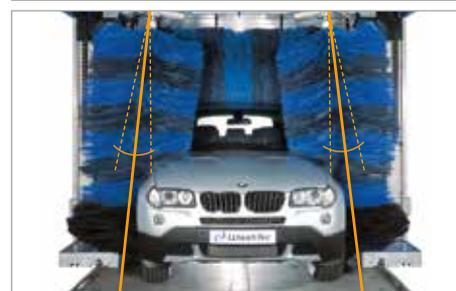
Pendant le cycle de lavage, les brosses latérales s'inclinent suivant un angle calculé automatiquement en fonction du profil du véhicule. Le niveau de propreté obtenu est remarquable, quelle que soit la forme de la carrosserie.
