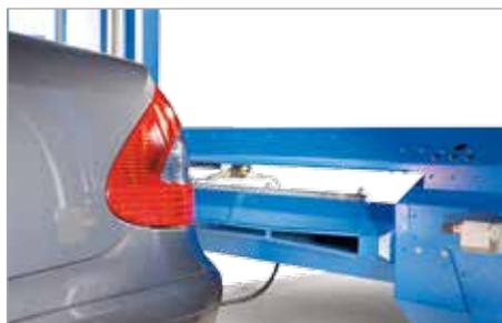
La buse de toit pivotante multifonction permet : une application plus précise des produits de lavage, un lavage haute pression même au niveau des bas de caisse et un séchage en suivi de contours. Nettoyage optimal, même des zones difficilement accessibles, comme celle des pare-chocs avant et arrière.
