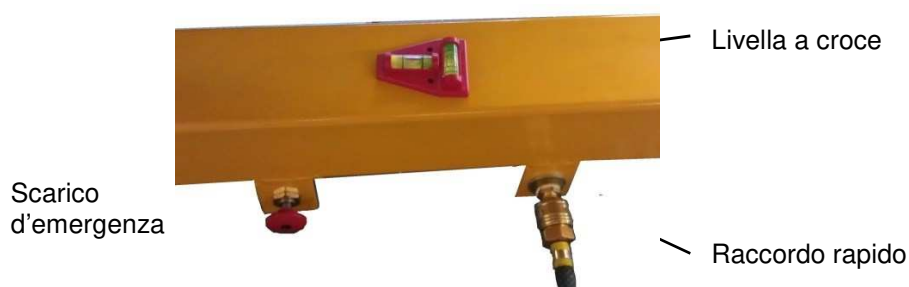
Figura 2: Livella a bolla d'aria
