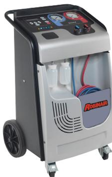
L'ACM3000yf-PROB est le modèle d'entrée de gamme pour le spécialiste des climatiseurs. Il offre toutes les fonctions de base et les performances nécessaires pour une utilisation professionnelle avec des climatiseurs basés sur le réfrigérant R1234yf. L'appareil exécute automatiquement la récupération, le recyclage et le remplissage du réfrigérant et garantit un séchage rapide et complet du système de climatisation. Une imprimante intégrée permet de réaliser des impressions pour le client.
