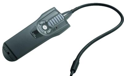
Un Formig Gas, composé de 95% d'azote et 5% d'hydrogène, est introduit dans l'installation de climatisation vide. Les conduites et les composants sont maintenant scrutés avec le localisateur de fuites. Lors de la moindre fuite, l'appareil localise l'hydrogène et donne un alarme acoustique et optique. Sensibilité: <(><<> 5 g/an Temps de réponse: 2-3 sec. Temps de préchauffage: max. 20 sec. Longueur de la sonde: 43 cm Temps de fonctionnement: min. 8 h
