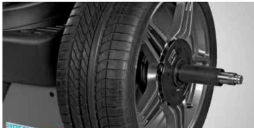
Die Power Clamp spannt das Rad elektromechanisch präzise unter konstanter Kraftanwendung auf und verhindert, dass «nachgewuchtet» werden muss.
