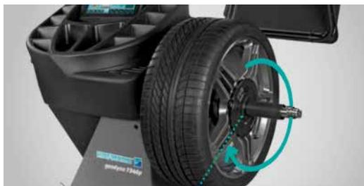
Beim Berühren des Bildschirms wird das Rad automatisch in die Position zur Anbringung der Gewichte gedreht.
