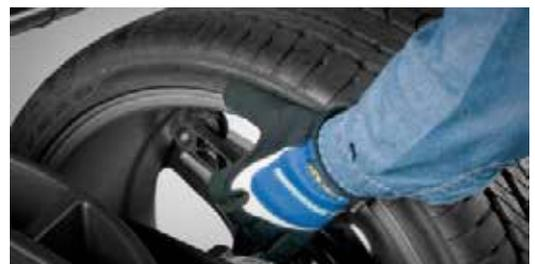
Die Felge muss nur mit dem Messarm berührt werden, um die Felgenmasse zu erfassen und den Auswuchtmodus automatisch anzuwählen.
