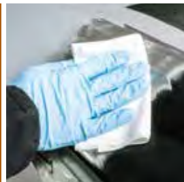
Flächen mit TEROSON VR 10 reinigen und vorbereiten
