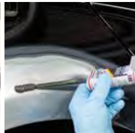
Auftragen von TEROSON EP 5010 TR/TEROSON EP 5020 TR
