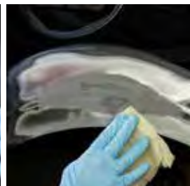
Optionales Auftragen von BONDERITE M-NT 1455-W auf blanke Metalloberflächen. Ca. 5 Min. ablüften lassen.
