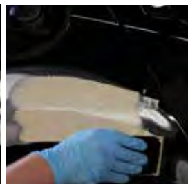
Auftragen von Spachtel TEROSON UP 210
