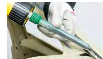
Einfache Verarbeitung mit Statikmischer
