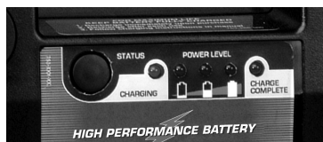
Prüfknopf, Aufladen, Stromlevel und LEDs für „Aufladen abgeschlossen“
