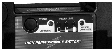
Botón de prueba, indicadores LED de carga en curso y unidad cargada
