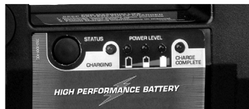
Testknop, Opladen, Voedingsniveaus en Opladen Voltooid LED's
