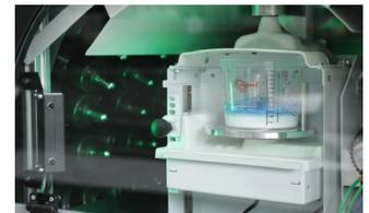
Der Dosiervorgang ist abgeschlossen, wenn die grüne Anzeige aufleuchtet. Den Mischbecher mit der ausgemischten Farbe entnehmen, gründlich umrühren und wie gewohnt auftragen (Hierbei kann ein Rotogen helfen). Das Daisy Wheel 3.0 hat ein automatisches Reinigungsprogramm, das jedes Dosierventil nach Gebrauch reinigt.
