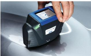
Verwenden Sie Ihr **Genius iQ-Spektrophotometer**, um den Farbton am Fahrzeug zu messen. Es ist klein und handlich in der Hand zu halten, intuitiv in der Bedienung und extrem genau im Messergebnis.
