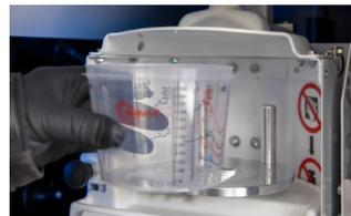
Das Daisy Wheel enthält Standobluie Mischfarben. Der Anwender stellt einen Mischbecher auf die Waage des Geräts, schließt die Frontklappe und wählt im Daisy Wheel-Steuerungsbildschirm "Start", um den Dosiervorgang zu starten.
