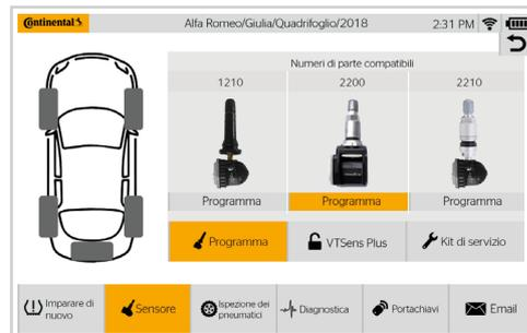
La programmazione dei sensori universali può essere eseguita rapidamente: ruota per ruota - o anche contemporaneamente per l'intero treno di pneumatici, ideale per le ruote invernali. Il successivo apprendimento tramite interfaccia OBD-II richiede meno di 90 secondi.
