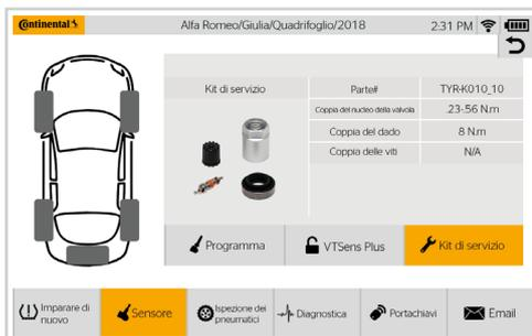
Con la funzione del kit di assistenza è possibile consultare i codici delle parti di ricambio e le coppie di serraggio per le valvole dei sensori. Viene inoltre visualizzata un'immagine del kit, per evitare errori di identificazione.
