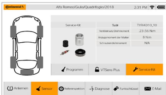
Mit der Service-Kit Funktion können die Ersatzteilnummern und Drehmomente für Sensorventile aufgerufen werden. Zusätzlich wird ein Bild des Kits angezeigt, um Fehlidentifikationen sicher zu vermeiden.
