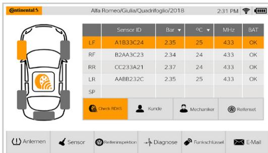
Der Fahrzeugbildschirm dient zum Auslesen der Sensoren und erfasst die Kundeninformationen direkt am Fahrzeug. Zusätzlich werden alle Sensorinformationen wie Sensor-ID, Druck, Frequenz und Temperaturstatus angezeigt und können als Bericht gespeichert werden.
