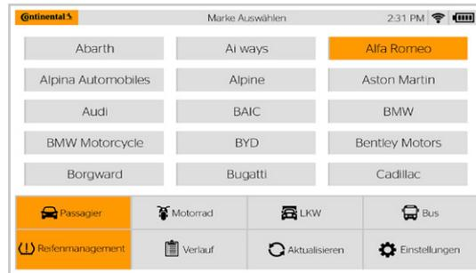
Nach der einfachen Fahrzeugauswahl stehen direkt alle ausführbaren Funktionen zur Verfügung. Die dynamische Menüführung ermöglicht jederzeit die Auswahl anderer Funktionen ohne Umweg über das Hauptmenü.
