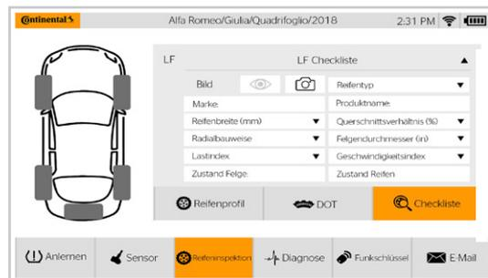
Mit der Reifeninspektion Funktion kann man jeden Reifen und jede Felge überprüfen und Notizen zu eventuellen Schäden oder Vorschlägen eingeben, die Reifenprofiltiefe messen und Informationen zur DOT aufzeichnen. Durch Tippen auf das Kamerasymbol lassen sich außerdem Bilder für Dokumentationszwecke aufnehmen.
