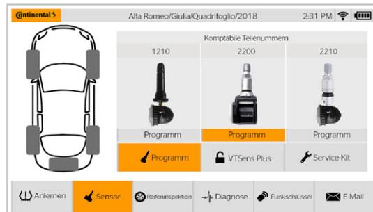
Die Programmierung von Universalsensoren lässt sich schnell erledigen. Rad für Rad - oder auch für den gesamten Reifensatz gleichzeitig, ideal für Winteräder. Anschließendes Anlernen per OBDII-Schnittstelle dauert weniger als 90 Sekunden.
