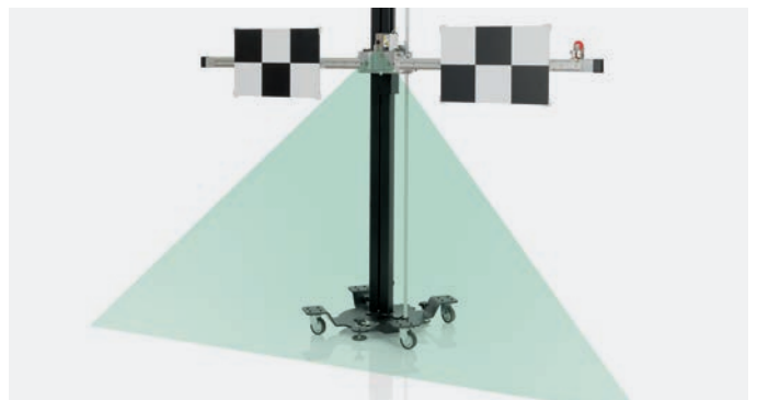
Allineamento rispetto ai riferimenti sul pavimento con il modulo laser
