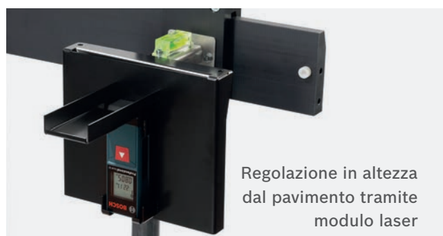
Misurazione della distanza dal sensore radar tramite modulo laser
