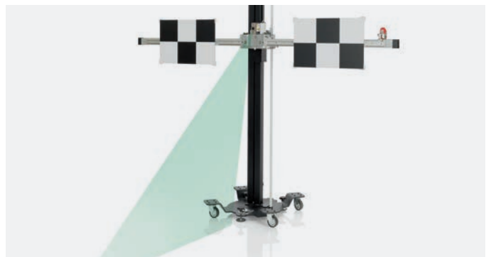
Allineamento rispetto al veicolo con modulo laser
