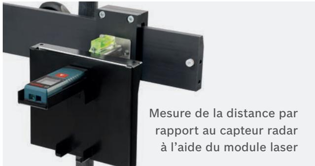
Mesure de la distance par rapport au capteur radar à l'aide du module laser
