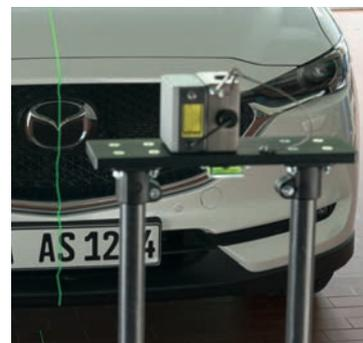
Module laser générant une ligne verte: positionnement sur le plan longitudinal médian du véhicule
