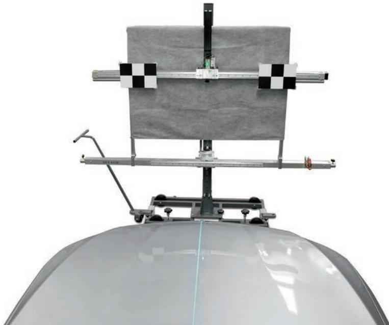
L'ajout de la SCT 1415 à l'équipement du DAS 1000 permet d'atteindre une compatibilité maximale pour l'étalonnage de la caméra avant. En combinaison avec les panneaux d'étalonnage disponibles en option, vous pourrez étendre vos prestations d'entretien à toutes les principales marques de véhicules européennes, japonaises et coréennes.
