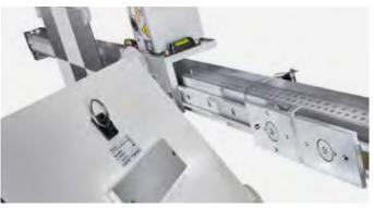
Kalibriertafeln einfach mit Magnethaltern am Präzisionsschlitten anstecken
