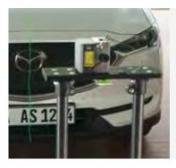
Grünes Linien-Lasermodul: Ausrichtung auf die Fahrzeuglängsmittelebene
