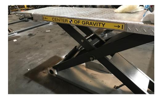
Lorsque le pont est fixé au sol à l'aide de chevilles de fixation, la répartition de la charge sus-mentionnée est valable et l'autocollant "centre de gravité" n'est plus valide.
