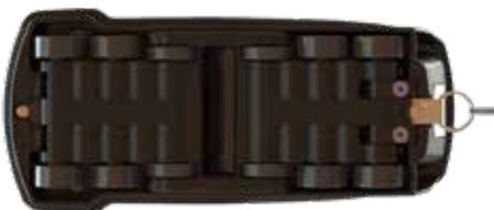
Um das optische Fenster zu reinigen, lösen Sie die Rädergruppe an der Unterseite des Scanners, indem Sie die zwei Halteclips drücken. Dadurch kann sich die Rädergruppe an einem Scharnier vom Scanner wegrehen.
