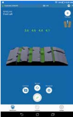
Dieser Menüpunkt erlaubt es dem Nutzer, einen einzelnen Reifen zu scannen, ohne ein Autokennzeichen eingeben zu müssen. Der Quick Scan kann zum Beispiel verwendet werden, um einem Kunden zu zeigen, wie der Scanner funktioniert.
