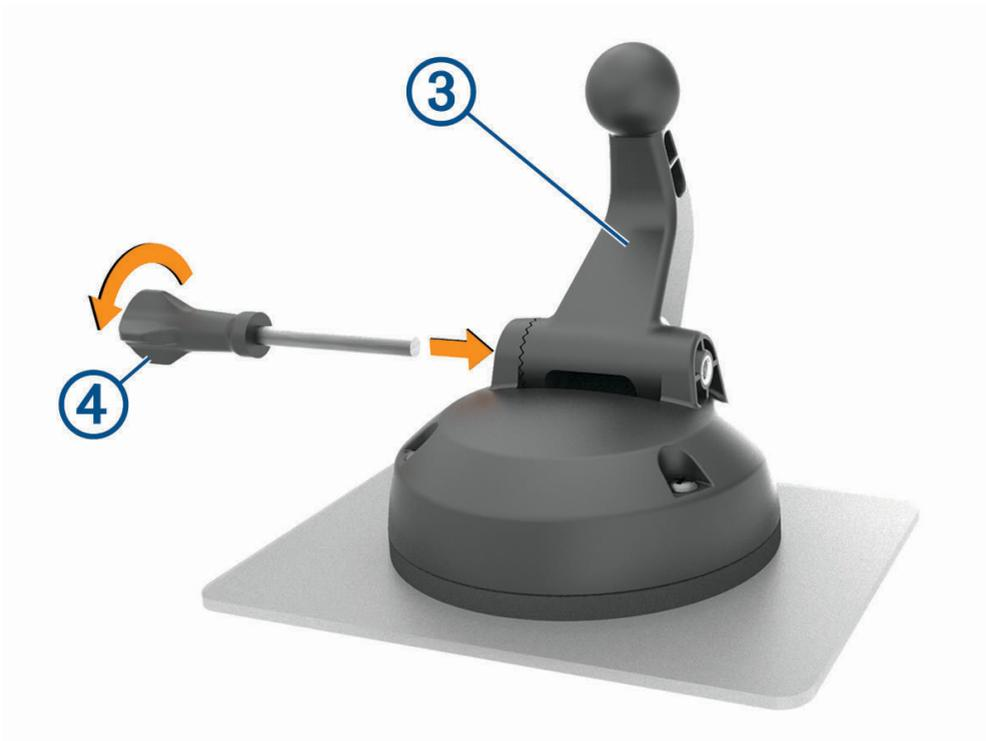
6 Insérez la vis de serrage ④ dans le support, puis serrez pour la fixer au bras du support à rotule.
