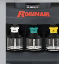
Le danger d'une contamination croisée de lubrifiants (PAG/POE) est évité grâce au système d'injection d'huile indépendant, aux bouteilles étanches (pouvant être remplies par l'utilisateur) et au cycle de rinçage des tuyaux d'entretien automatisé à chaque changement d'huile.
