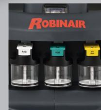
Il pericolo di contaminazione (PAG/POE) tra lubrificanti è evitato grazie al sistema d'iniezione olio indipendente, ai serbatoi a tenuta riempibili dall'utente e al ciclo di lavaggio dei tubi flessibili di servizio che è automatizzato ad ogni cambio dell'olio.
