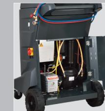
Il prodotto è stato sviluppato basandosi su un design modulare, con un facile accesso ai componenti interni per ridurre i tempi di manutenzione di AC.
