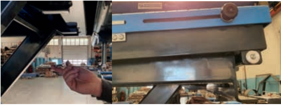
Figure 5.3.1 Point de réglage de l'inclinaison de la plate-forme
