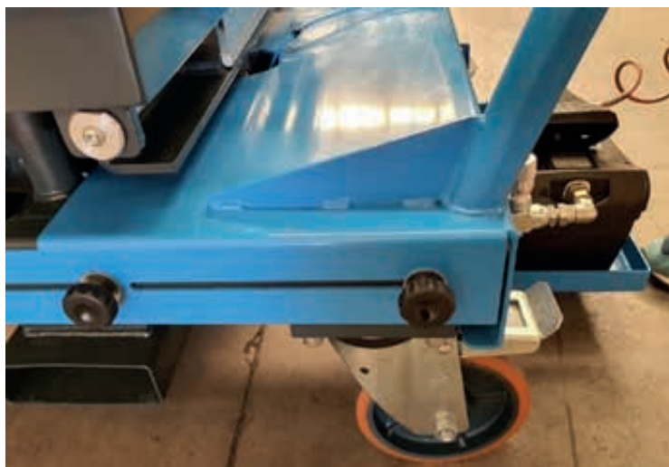
Figure 5.6.1 Système de réglage de base de l'élèveur
