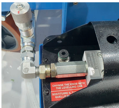
Figure 6.3.4 Étiquette sur la pompe pneumo-hydraulique : remplacer le bouchon avec celui en dotation »
