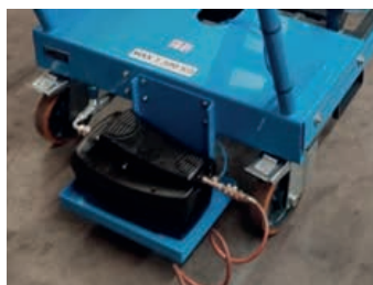
Figure 4.3.1 Raccordement de la ligne pneumatique
