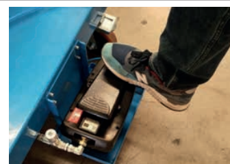
Figure 5.2.2 Photo de la pédale - actionnement de la montée
