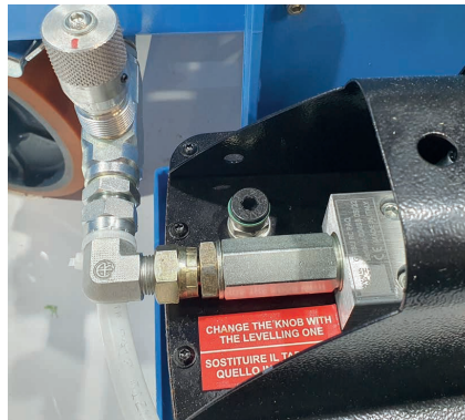
Figura 6.3.4 Etichetta su pompa pneumatica: "sostituire il tappo con quello in dotazione"
