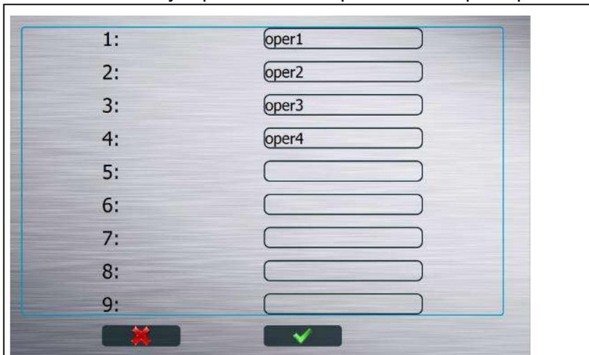
Dans le menu principal, pour sélectionner le nom de l'opérateur, il suffit d'appuyer dans la zone supérieure droite et de choisir l'opérateur. Ce nom sera inscrit sur le rapport de test à la fin d'un test.
