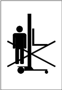
Interdiction de monter sur l'élévateur pour roues
