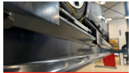
Gekantetes Profil für hohe Fahrbahnstabilität
