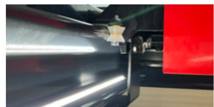
Suspension à rouleaux du cric à l'intérieur du profil du chemin de roulement
