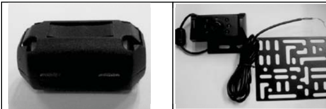
5. Ferritkern für das Kamerakabel zur Störungsunterdrückung
