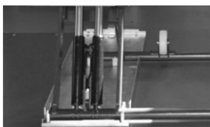
Doppeltes Hydrauliksystem, somit keine Druckluft erforderlich
