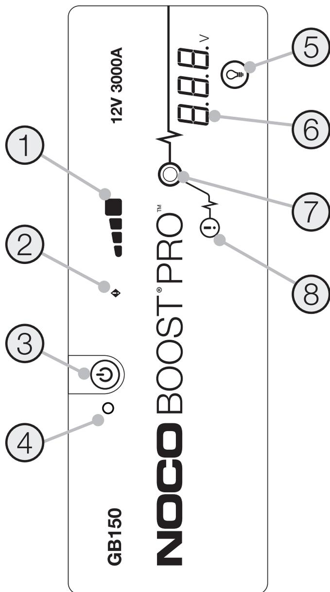
**1.) Il livello della batteria interna** Indica lo stato di carica della batteria interna.
