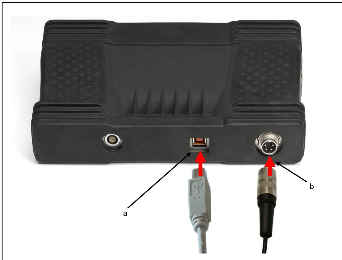
Fig. 2-1 Raccord câble USB et alimentation
