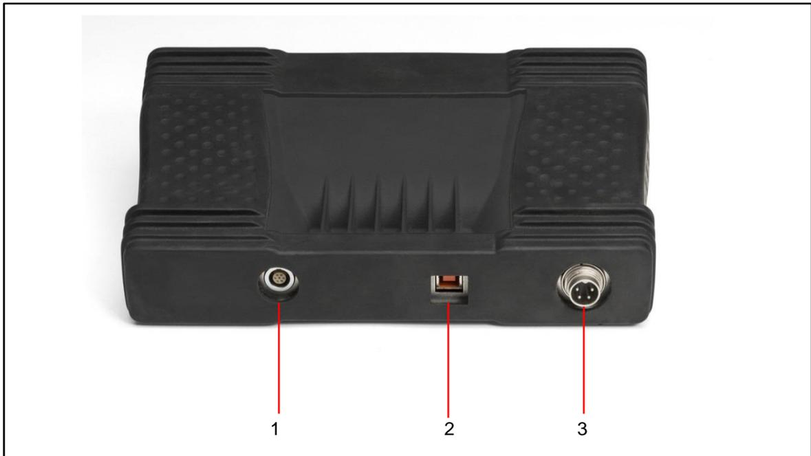
Fig. 1 2 Vue arrière AVL DiTEST SCOPE 1400
