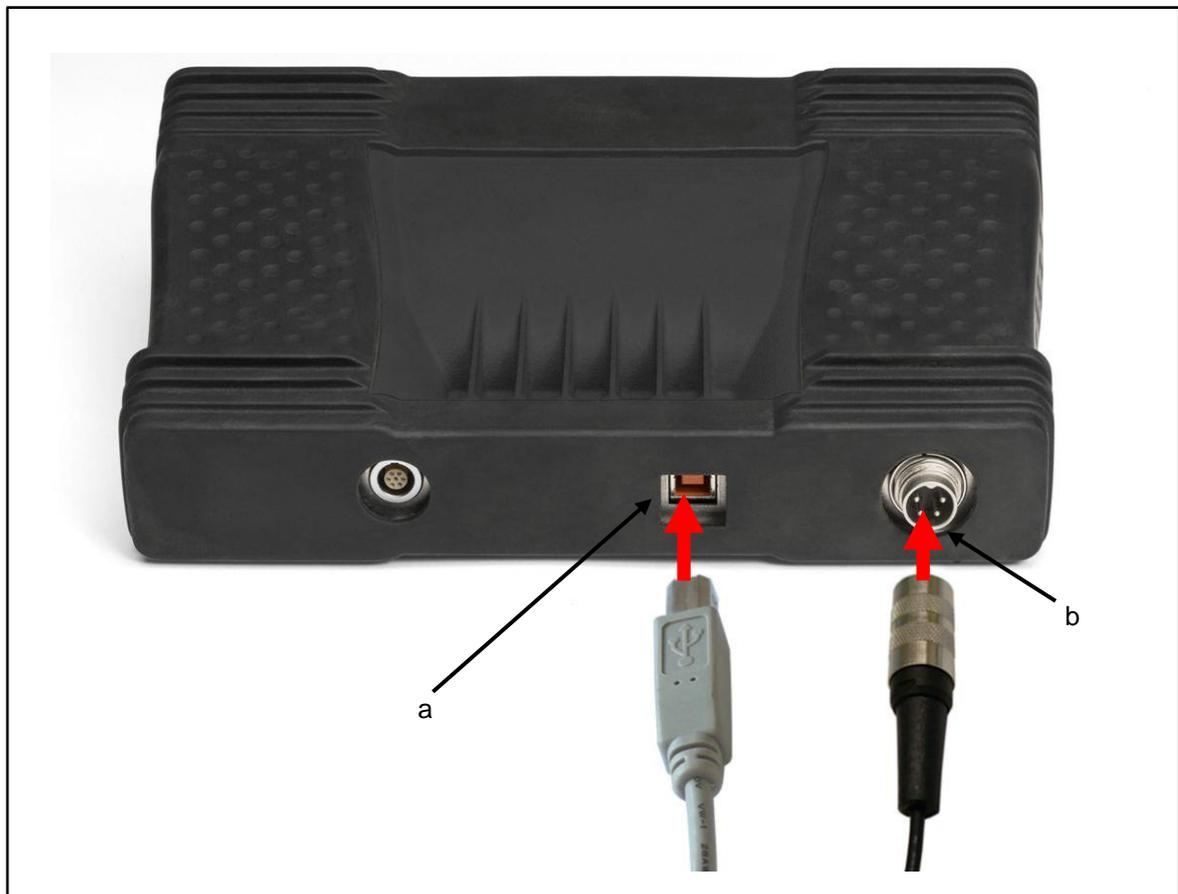
Abb. 2-1 Anschluss USB und Spannungsversorgung
