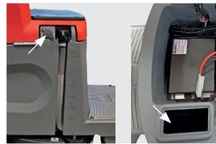
Einfüllöffnung (Schlauch oder Eimer) und Skala für Frischwassertank
