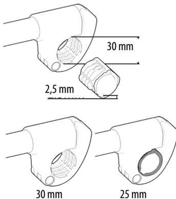
Figura 3: Regolazione del diametro del bullone a U
