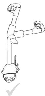
Figura 2: Ribaltamento del supporto del telaio
