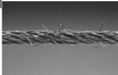
Unzulässiges Stahlseil - stark zusammengedreht
