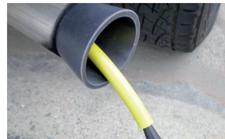
Leakfinder kann auch Undichtigkeiten im Auspuff-System finden
