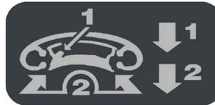
➤ Dans la position 1, le gonflage des pneus a lieu avec le manomètre et le flexible de gonflage.
