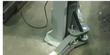
Überschwenkbare Tragarme für bessere Einfahrsituation
