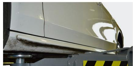
Flache Schwenkarmkonstruktion < 100 mm
