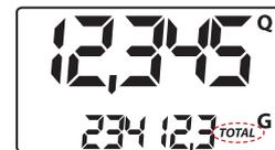
Nach dem Drücken der RESET-Taste zeigt das Display während der Nullstellung nacheinander zunächst alle eingeschalteten Ziffern und dann alle ausgeschalteten Ziffern an.
