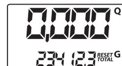
Und nach wenigen Sekunden wird RESET TOTAL durch die NICHT nullbare Gesamtmenge TOTAL ersetzt.
