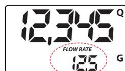
Die Schrift GAL neben der Flow Rate bezieht sich auf das Register der (nullbaren oder NICHT nullbaren) Gesamtmenge, die erneut angezeigt wird, wenn der Anzeigemodus der Durchflussmenge wieder verlassen wird.
