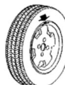
3. Appliquer manuellement sur la jante en position 12 heures la quantité de poids indiquée sur l'écran (appliquer des poids à ressort):
