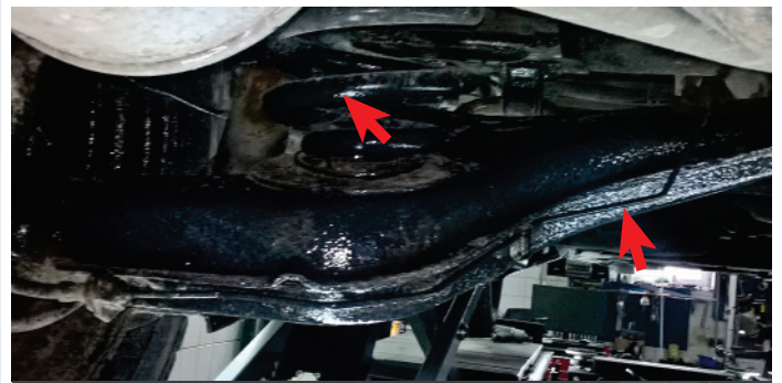
Korrosionsschutz bei Achsträgern
