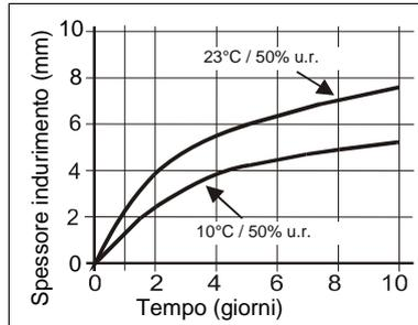
Diagramma 1: Velocità di indurimento di Sikaflex®-521 UV
