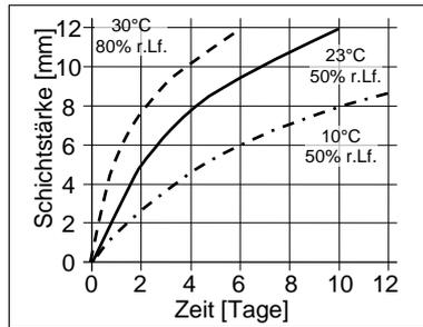
Diagramm 1: Durchhärtageschwindigkeit für Sikaflex®-268
