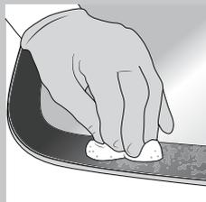
3. Mit unbenutztem Sika® Power Clean Aid die Klebefläche reinigen
